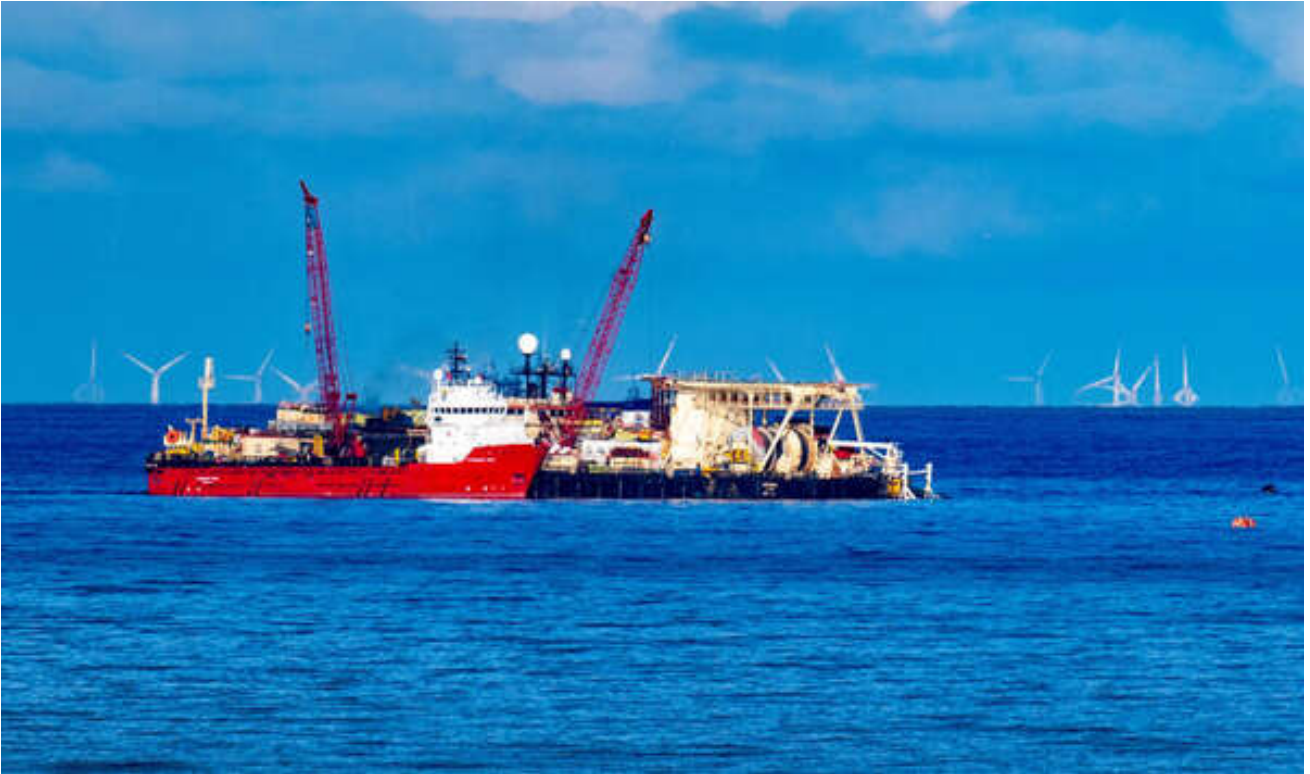
Bildunterschrift: Die FS „Standard Duke“ bringt die Rohre zum Pipeline-Verlegeschiff „Castoro 10“.
