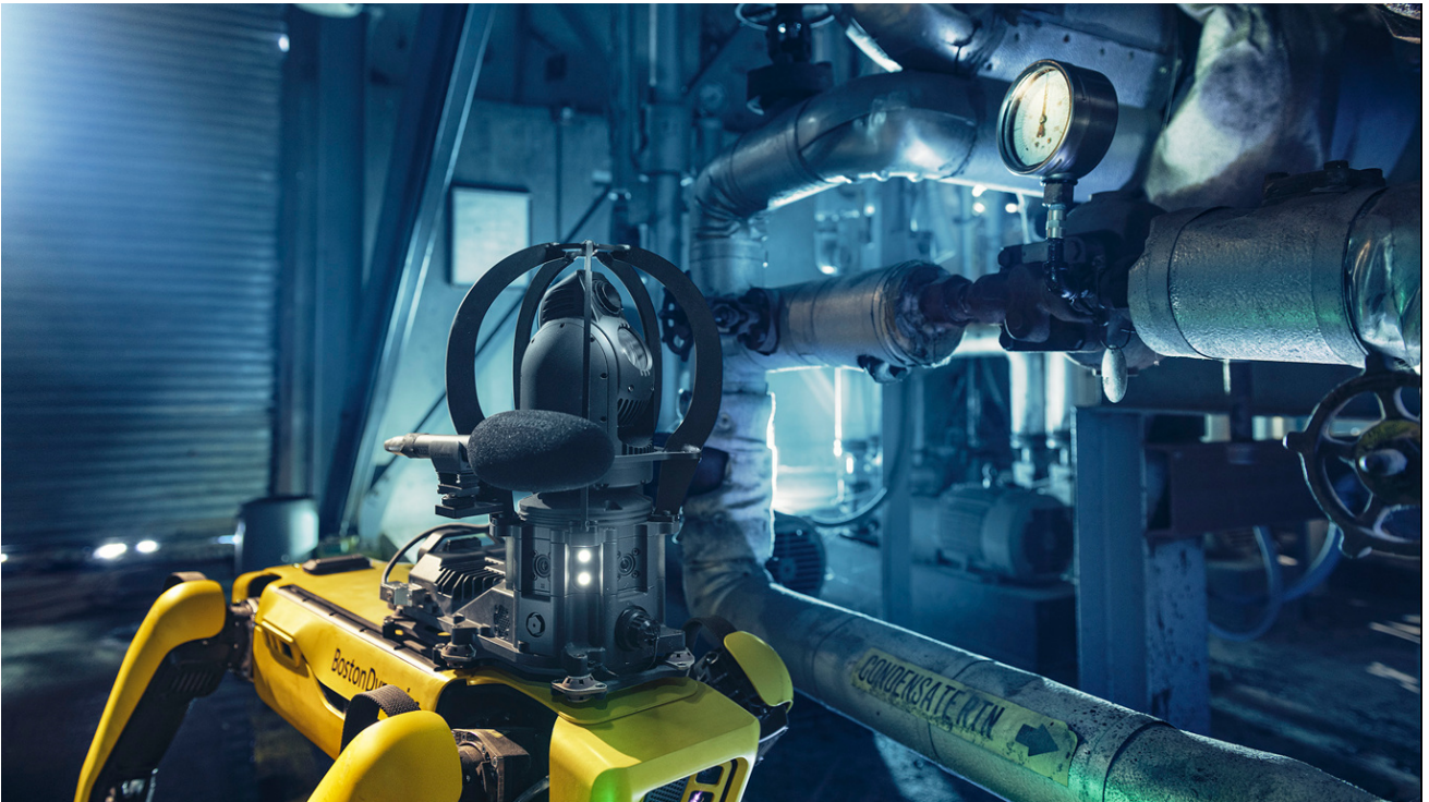
Bildunterschrift: Der Roboter-Hund Spot von Boston Dynamics hat sich bei der Inspektion von Kernkraftwerken bewährt. Foto: Boston Dynamics
