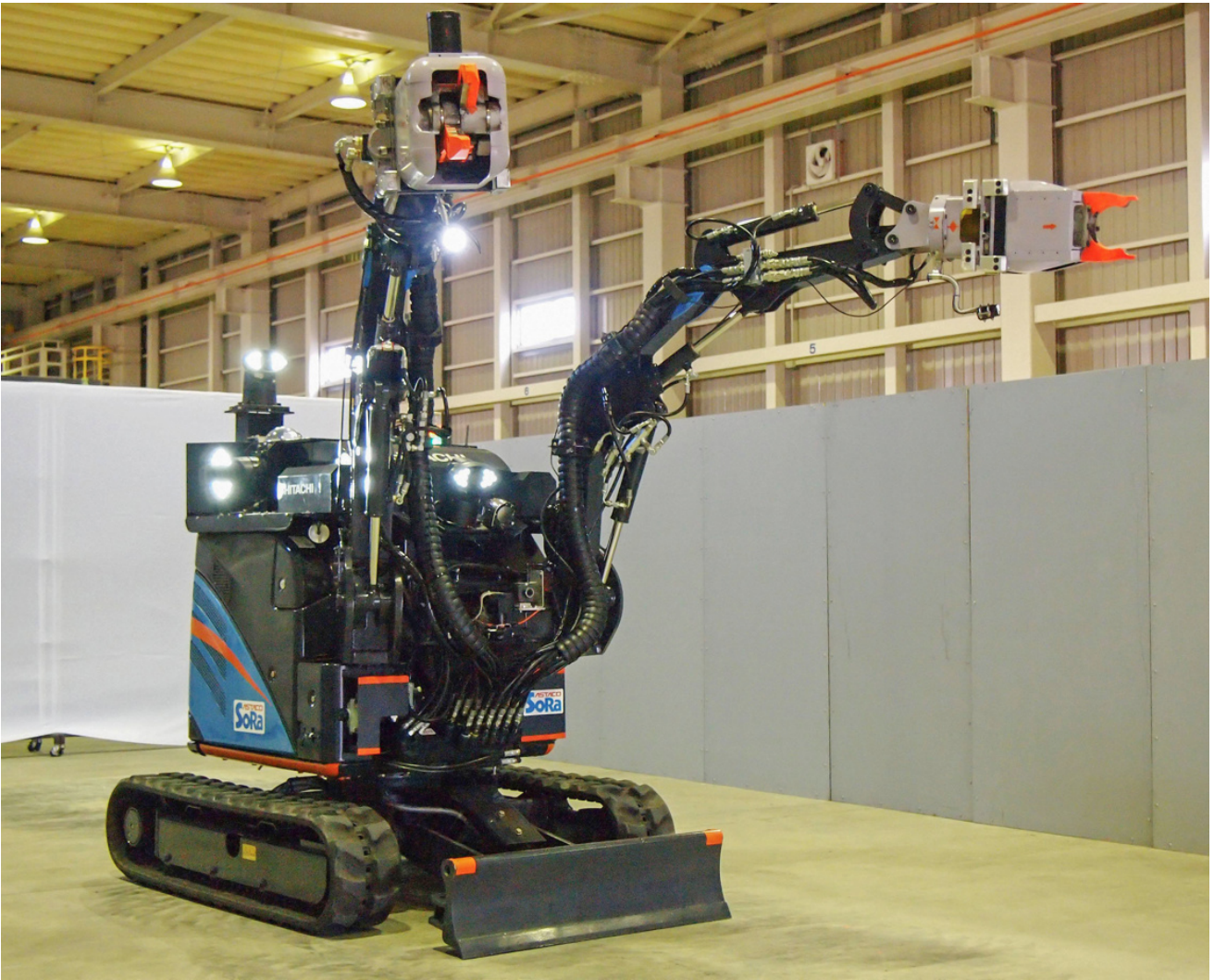
Bildunterschrift: Der ASTACO-SoRa ist ein für Fukushima entwickelter Räumroboter. Damit seine Steuerelektronik nicht unter der Radioaktivität leidet, wird er ferngesteuert. Foto: imago / Kyodo News
