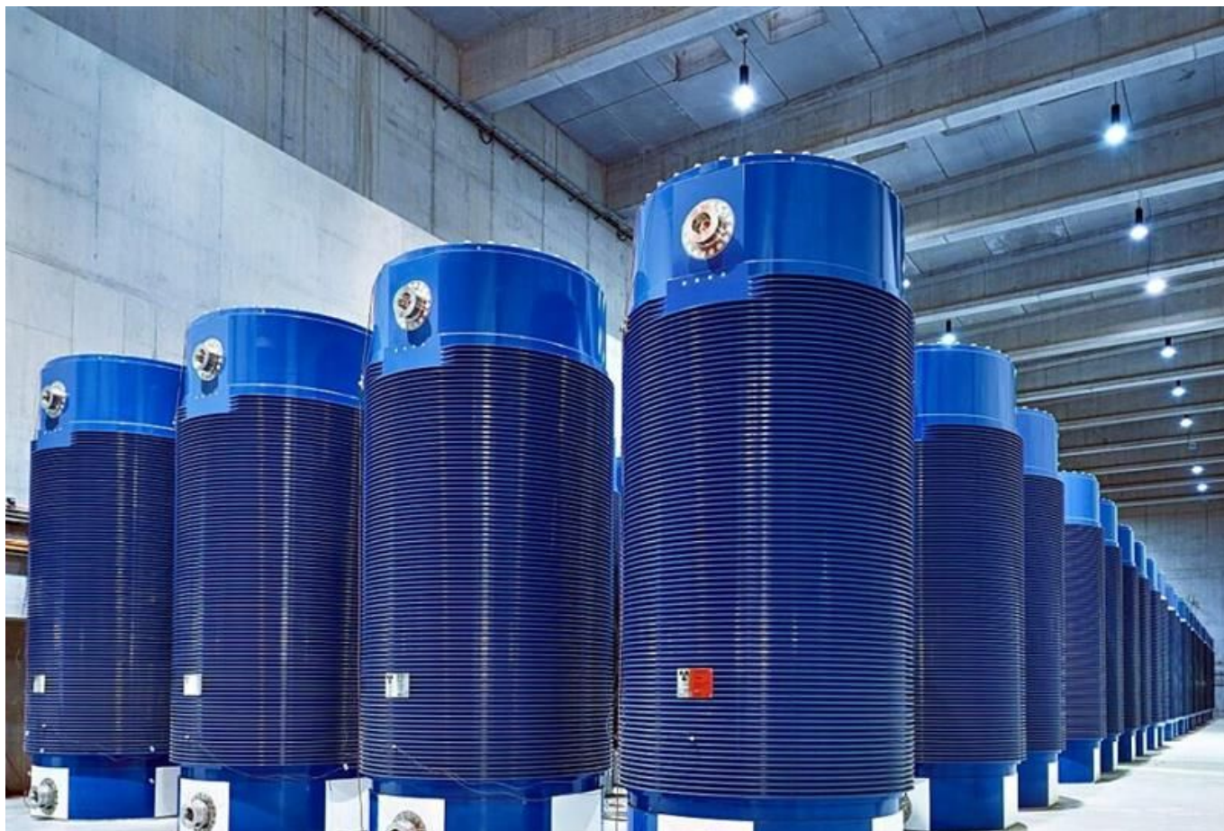
So sehen die Castor-Behälter im Zwischenlager in Gundremmingen aus. Darin lagert der Atommüll, der während der Laufzeit des Atomkraftwerks Gundremmingen entstanden ist.
